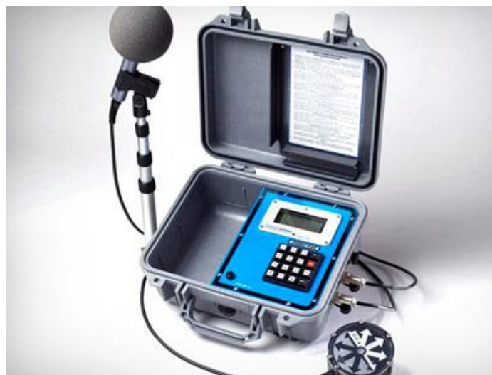
Εικόνα 4.4-5: Συσκευή μέτρησης δονήσεων εδάφους (Peak Particle Velocity – PPV) η οποία συμπεριλαμβάνει μικρόφωνο για την μέτρηση των αέριων δονήσεων και η οποία χρησιμοποιήθηκε στις εργασίες παρακολούθησης
