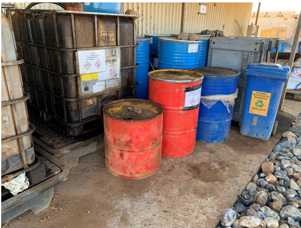
Εικόνα 4.6-2: Χώρος συλλογής επικίνδυνων αποβλήτων πλησίον συνεργείου
