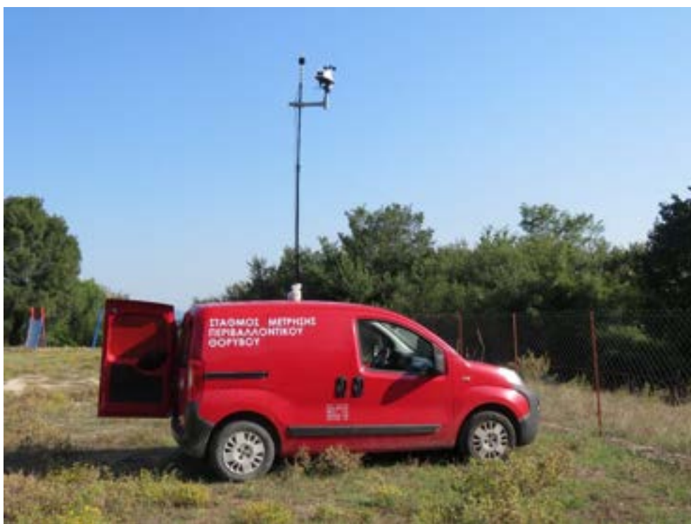
Εικόνα 4.4-3: Κατάλληλα σχεδιασμένο όχημα για τη διεξαγωγή 24ωρων μετρήσεων θορύβου. Στην εικόνα μπορεί να παρατηρηθεί το μικρόφωνο που εκτείνεται μέσω του οχήματος καθώς και ο μετεωρολογικός σταθμός
