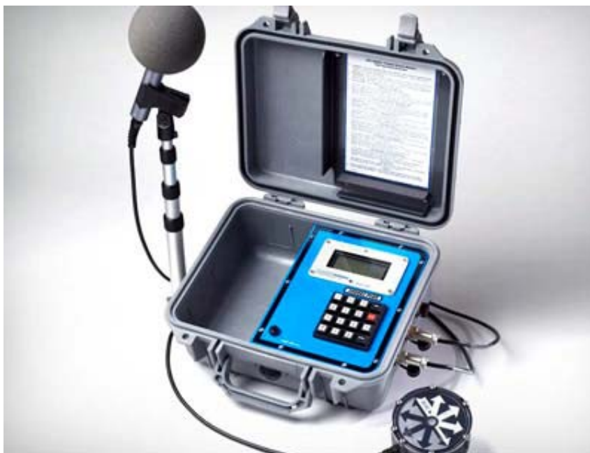
Εικόνα 9: Συσκευή μέτρησης δονήσεων εδάφους (PPV) η οποία συμπεριλαμβάνει μικρόφωνο για την μέτρηση των αέριων δονήσεων και η οποία χρησιμοποιήθηκε στις εργασίες παρακολούθησης
