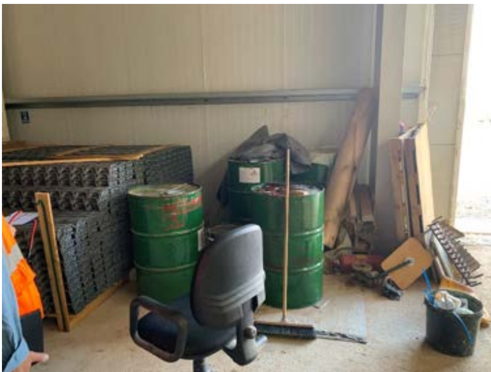
Εικόνα 21: Αποθήκευση επικίνδυνων ελαίων σε αποθήκη χωρίς προστατευτική βάση για διαρροές
