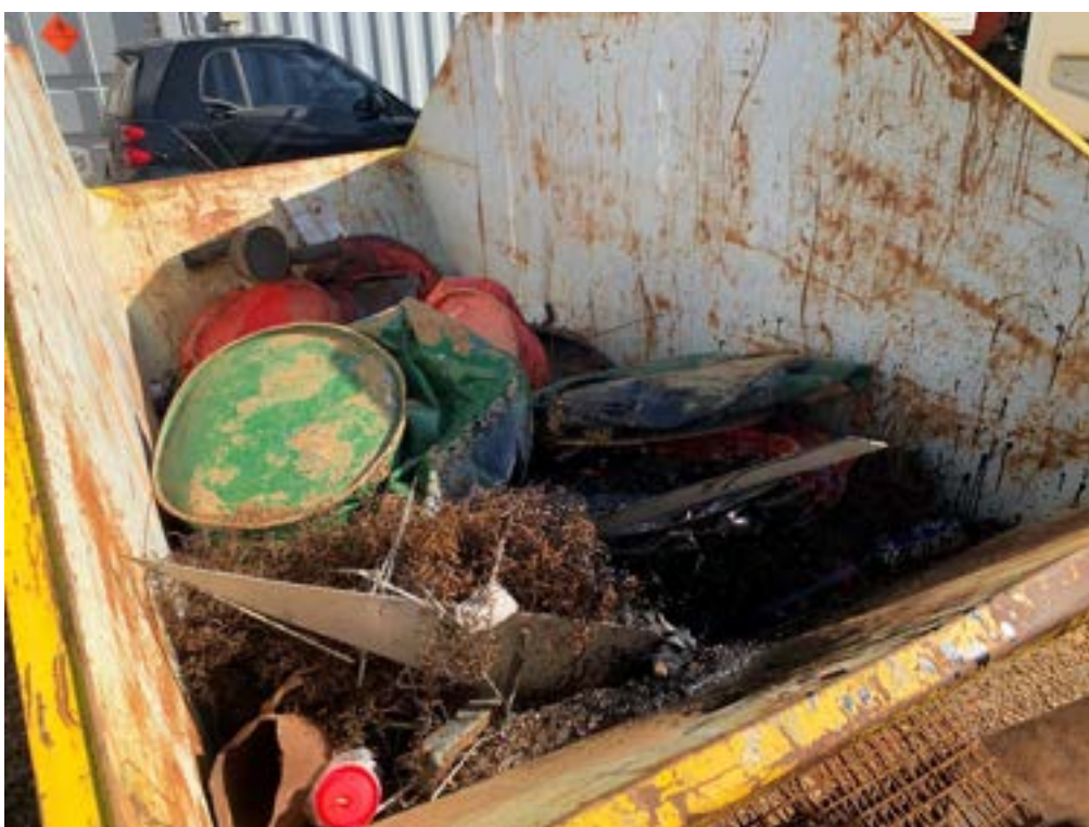
Εικόνα 8: Απόρριψη επικίνδυνων ελαίων σε κάδο που προορίζεται για scrap μέταλλα
