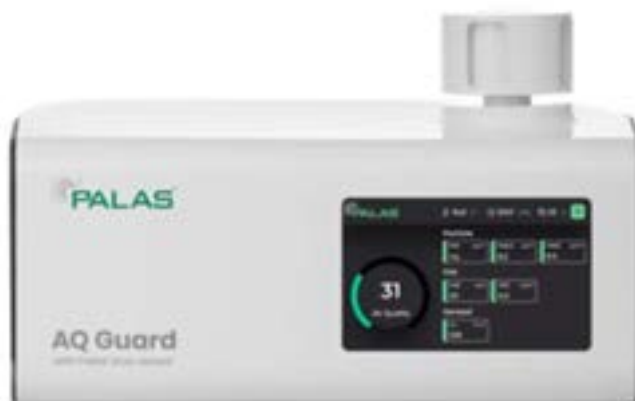
Εικόνα 11: Συσκευή μέτρησης επιπέδου σκόνης που χρησιμοποιήθηκε στις εργασίες παρακολούθησης
