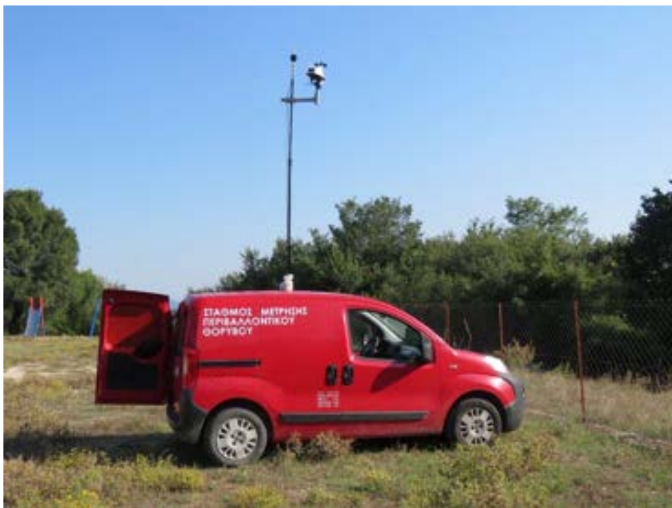
Εικόνα 4: Κατάλληλα σχεδιασμένο όχημα για τη διεξαγωγή 24ωρων μετρήσεων θορύβου. Στην εικόνα μπορεί να παρατηρηθεί το μικρόφωνο που εκτείνεται μέσω του οχήματος καθώς και ο μετεωρολογικός σταθμός
